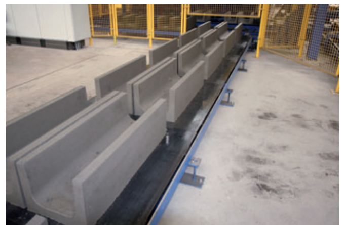
Canales en U en la Blizzard
