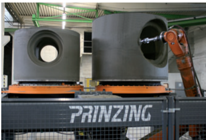
Primuss fresa canaletas variables y conexiones de forma completamente automática en las bases de pozos
