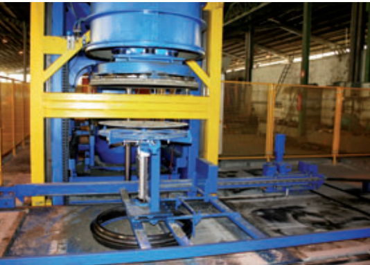
Tornado con macchina automatica degli ancoraggi
