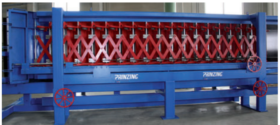
Cassaforma per scale Sirius con regolazione rapida
