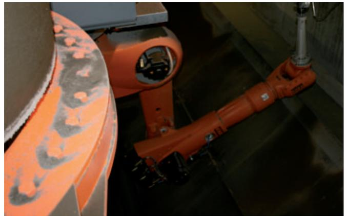
*La fossa sotto le stazioni di lavorazione serve come campo d'azione per il robot di fresatura.*
