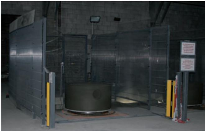
*La stazione di fresatura Primuss dispone di due stazioni di lavorazione a filo del pavimento.*
