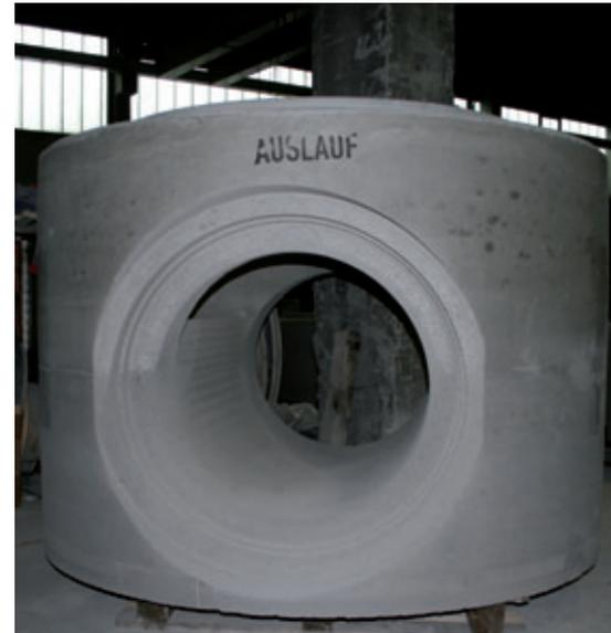
Fondo fresato per pozzetti NW 1.200 mm, altezza d'installazione 1.400 mm con raccordi fresati e canaline per i tubi in calcestruzzo FBS NW 800 mm.
