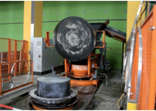
Innanzitutto avviene l'inserimento del manico inferiore e del cappello di supporto nell'impianto Atlas
