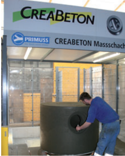
Segue l'operazione di spazzare i raccordi per i tubi
