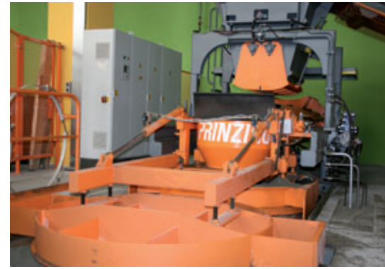
Segue la compattazione con carico verticale
