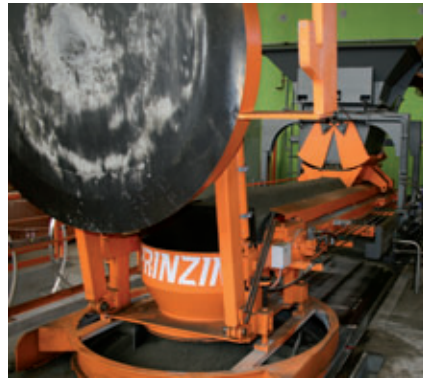
Le valvole di dosaggio gestiscono il flusso di calcestruzzo
