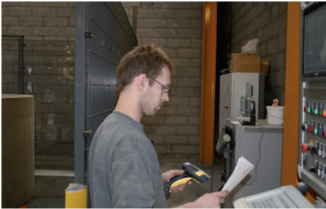
La scansione del codice a barre attiva il processo di fresatura
