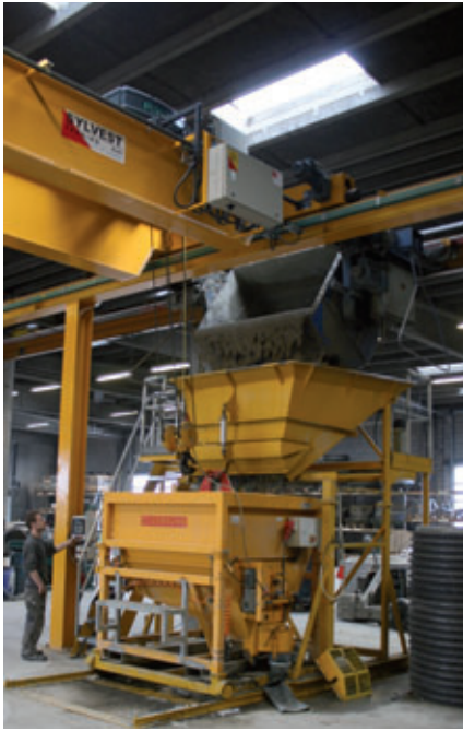
Consegna dell'SCC dal carro ponte con vagonetti aerei al distributore di calcestruzzo
