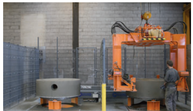
Stazione di fresatura Primuss con due postazioni di lavoro
