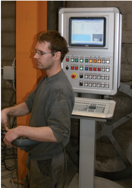
La velocità di fresatura si gestisce con il telecomando
