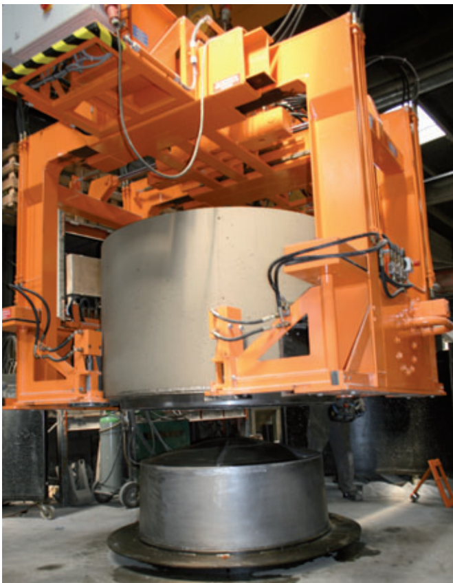
L'elemento in calcestruzzo disarmato viene portato dal manicotto inferiore
