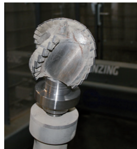
La testa di fresatura per fresare le canalette
