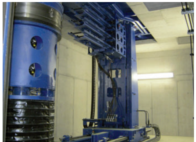
Magazzino gradini automatico per la produzione di anelli e coni per pozzetti
