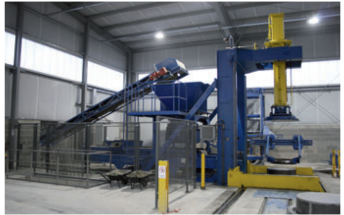
Macchina per pozzetti Tornado di Prinzing, completamente automatica
