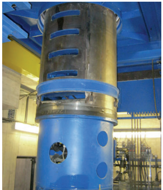
Anima dello stampo degli anelli per pozzetti per la vibrazione diretta di gradini
